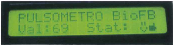
Fig. 10. Presentación visual ante una entrada de tren de pulsos con una frecuencia de 47 Hz
